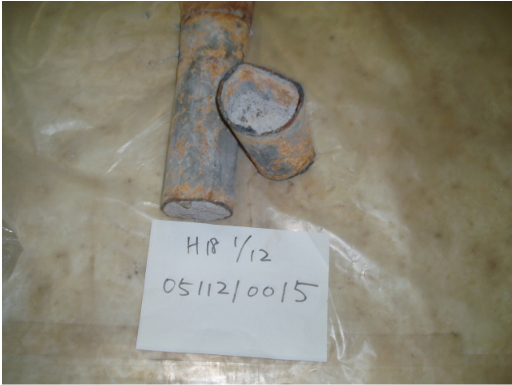
図 3.5.2 - 2 モルタルが充填されている配管
