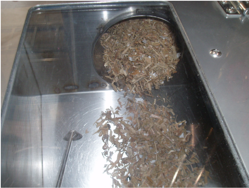
図 3.5.2 - 8 木枠の破碎状況
