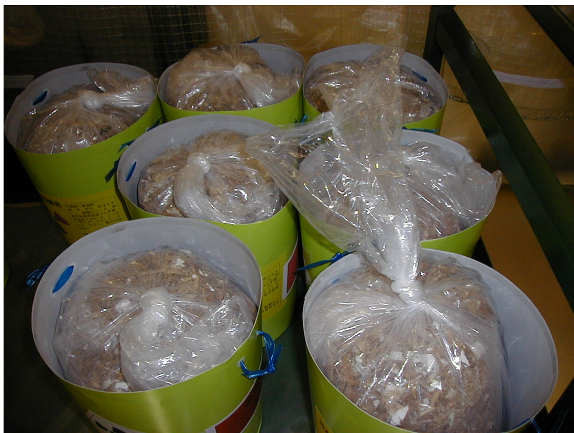
図 3.4.3-5 破砕後の HEPA フィルタの木枠
